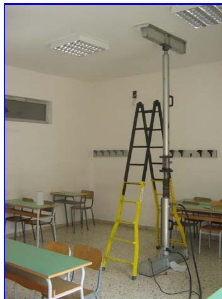
Solaio sottoposto a prova
