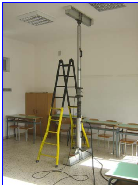
Solaio sottoposto a prova
